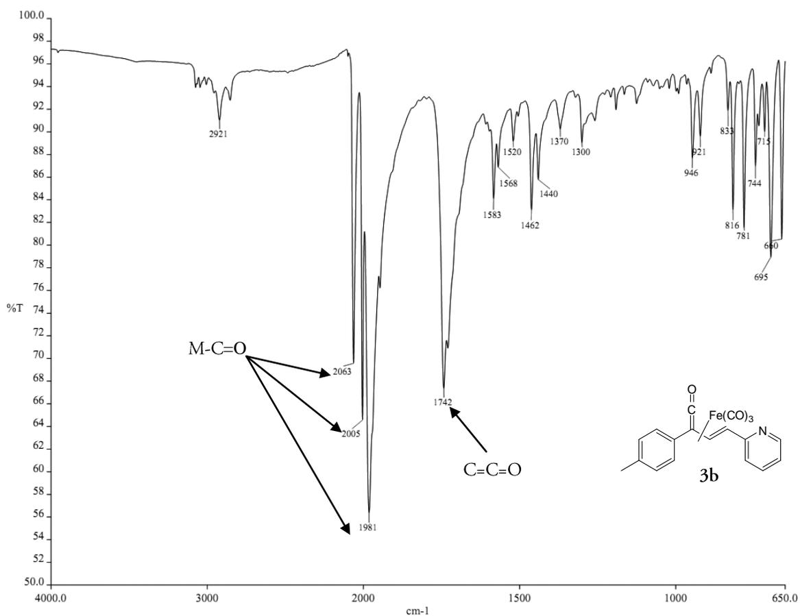
Figura 24. Espectro de IR del compuesto **3b**.
