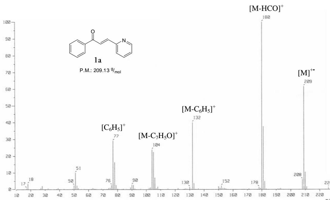
**Figura 13.** Espectro de Masas ( $IE^+$ ) del compuesto **1a**.
