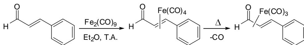
**Esquema 3.** Síntesis del primer complejo  $\eta^4$ -[Fe(CO)<sub>3</sub>] de un compuesto carbonílico  $\alpha,\beta$ -insaturado.
