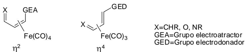
**Esquema 1.** Complejos  $\eta^2$ -[Fe(CO)<sub>4</sub>] y  $\eta^4$ -[Fe(CO)<sub>3</sub>] de dienos.
