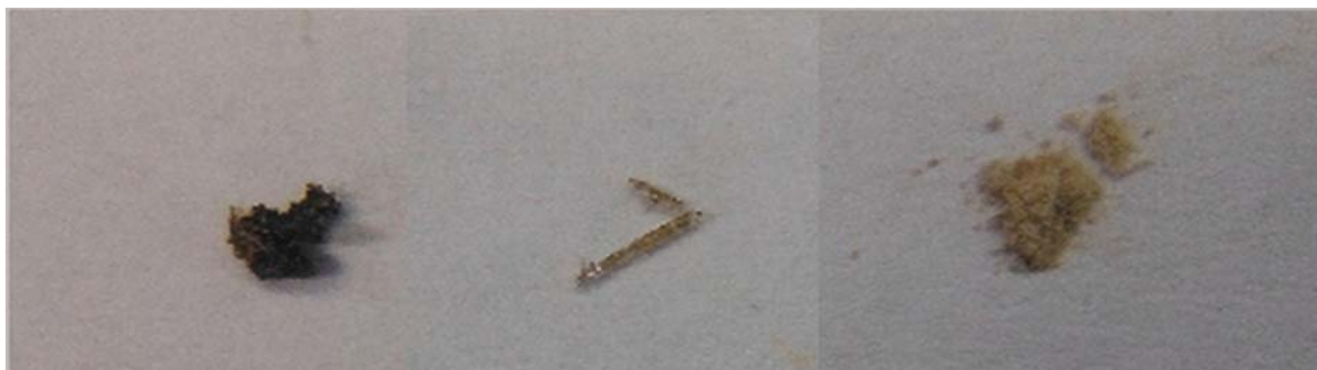
Figura 30. Cristales obtenidos del ligante dibromado en acetona; (a) cristal negro , (b) cristal transparente, (c) materia prima obtenida por precipitación con acetona.
